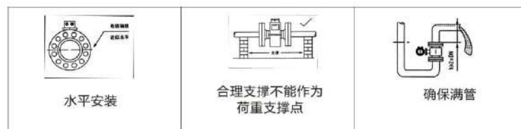
图六 正确安装流量计图示一
