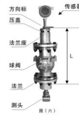
球阀插入式涡街仪表安装定位尺寸
